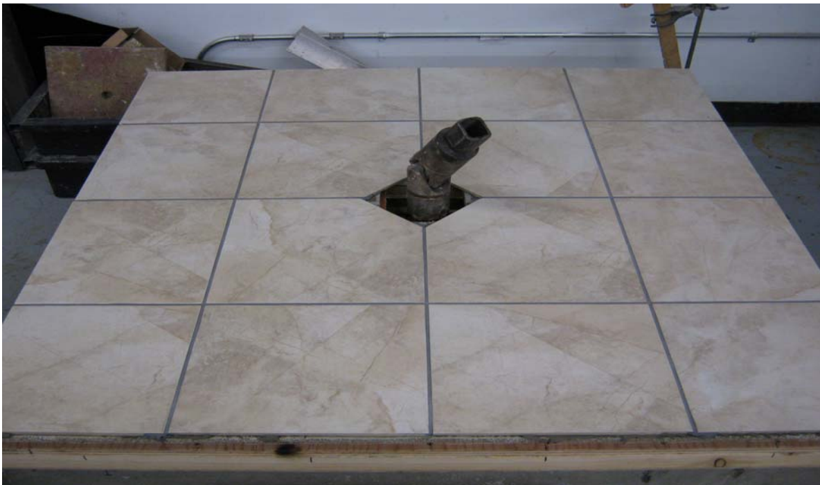
Figure 2 : Vue de haut du plancher assemblé (avant essai).
